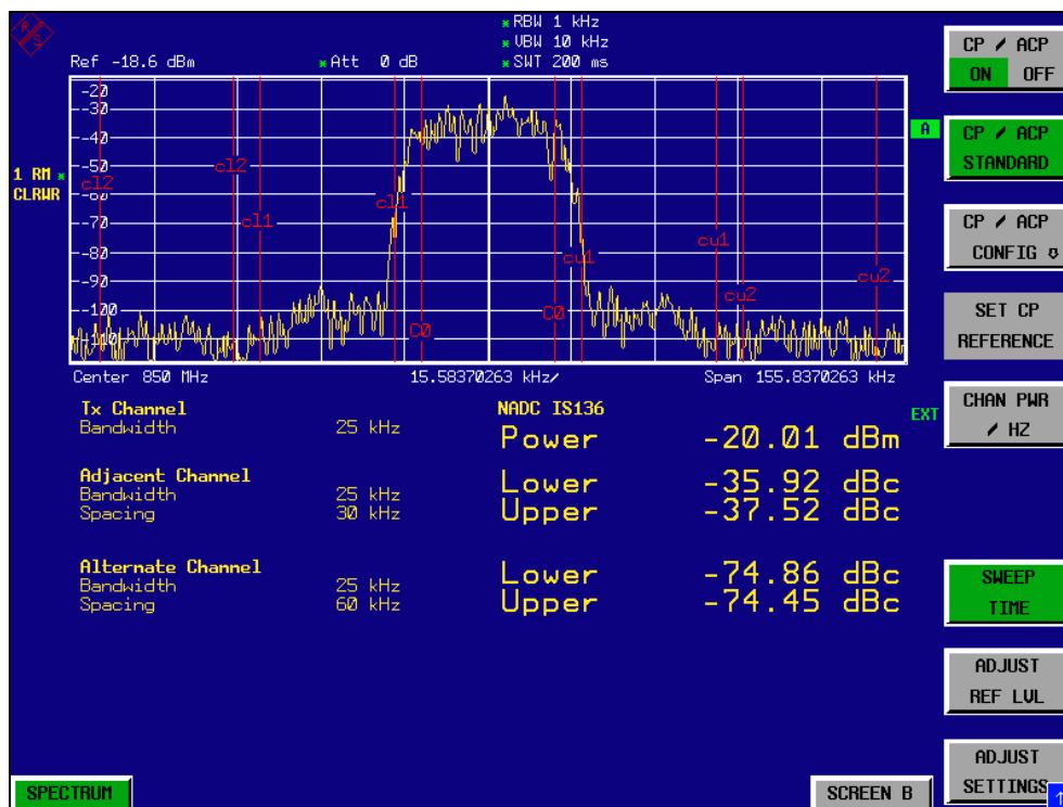
Fig. 2-1 Messung der relativen Nachbarkanalleistung eines NADC-Signals in je zwei Nachbarkanälen unterhalb und oberhalb des Sendekanals.
