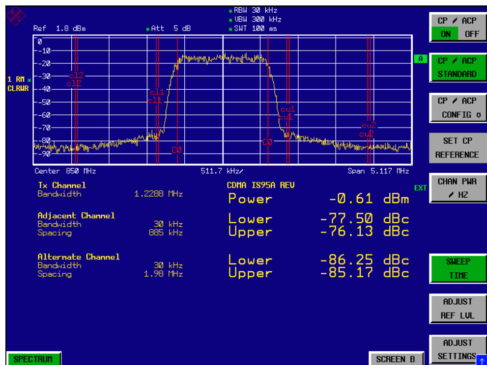
Fig. 2-6 Nachbarkanalleistungsmessung an einem CDMA IS95-Signal
